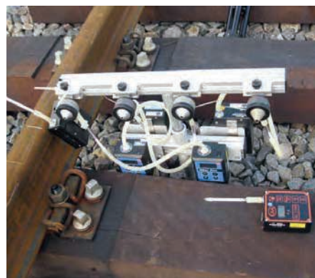
Abb. 4a, b: Analyse der Luft im Arbeitsbereich beim Verlegen von Neuschwellen (links) und Messgerät zur Luftanalyse unmittelbar über der Schwellenoberfläche (unten) (Fotos: BG BAU Prävention)
