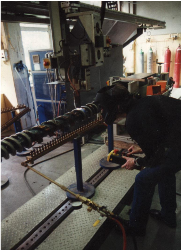
Bild 2: Prozessbeobachtung und Optimierung beim Auftragschweißen mit Robotern
