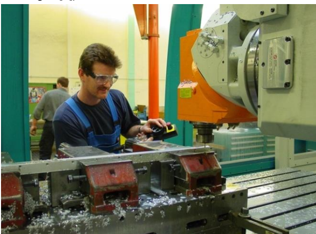
Bild 1: Prozessbeobachtung bei Einzelfertigung auf einem Bearbeitungszentrum. Im 1/100 mm-Bereich sind Störkanten zu glätten, wobei eine Kollisionsgefahr an Werkstückkonturen besteht.
