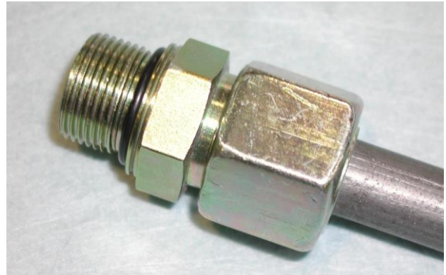
Bild 2: Beispiel einer genormten eindeutigen Kennzeichnung an Einschraubzapfen nach DIN EN ISO 6149 mit metrischem Gewinde für Rohranschlüsse mittels Kerbe (umlaufende Nut)
