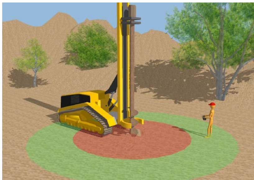
Abb. 6: Abstandsabhängige Bedienung eines Ankerbohrgerätes (Bild: Georg Nischalke-Fehn)
