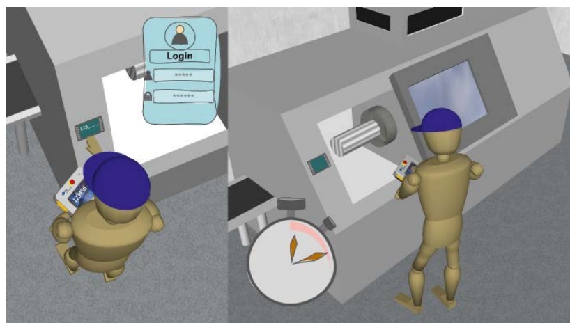
Abb. 3: Bedienerperson meldet sich an der Maschine an und kann sie innerhalb der Freigabedauer bedienen
