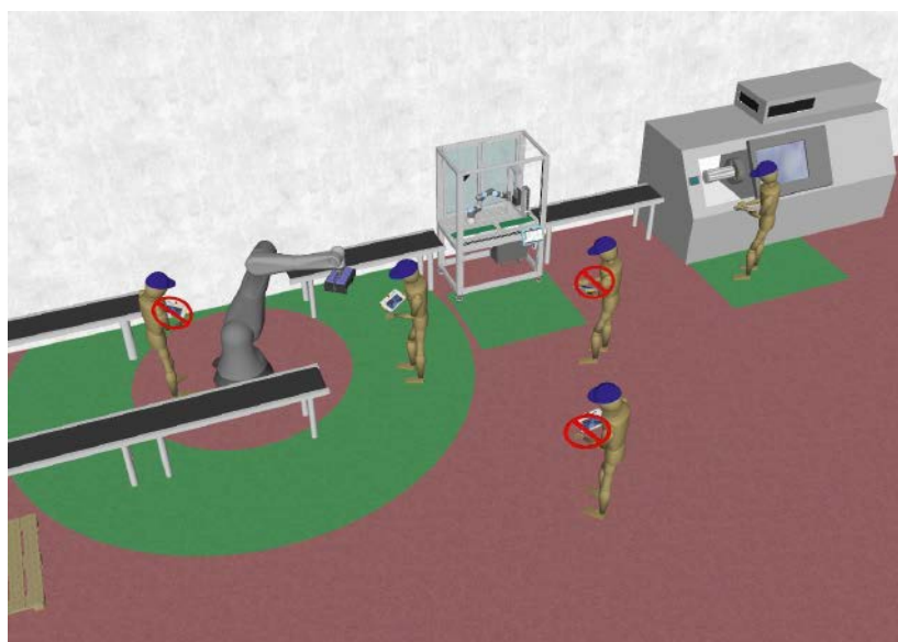
Abb. 1: Bedienpositionen an einer Fertigungsline (Bild: Georg Nischalke-Fehn)
