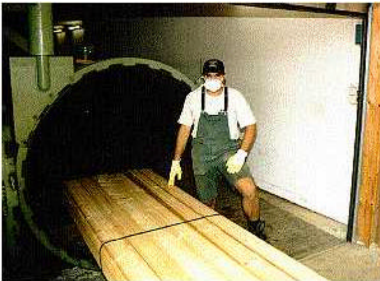
Abbildung Auftrag von Holzschutz- mitteln in einer Kesseldruckanlage
