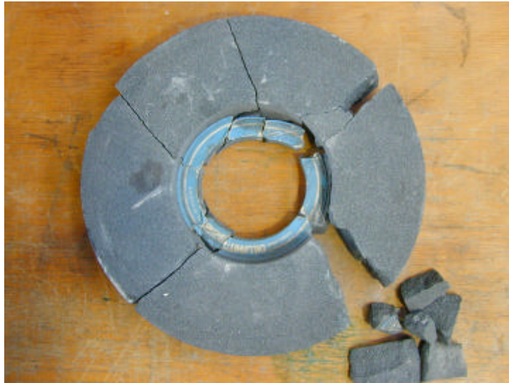
Abbildung 2-38: Während des Betriebes gebrochene Keramik-Schleifscheibe
