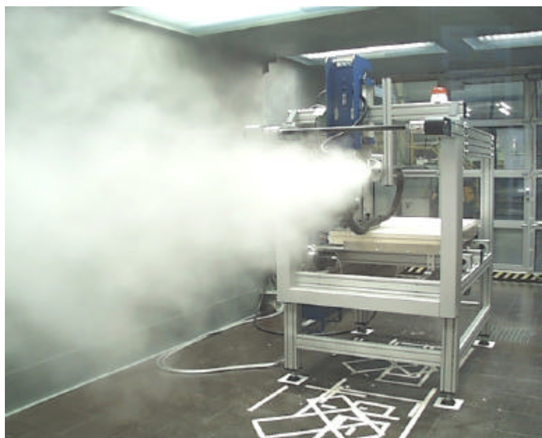
Abbildung 2-10: Teststaubanlage beim Schneiden von Gipsplatten
