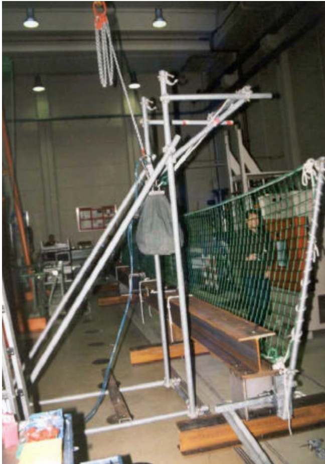
Abbildung 2-26: Pendelschlagversuch mit Glaskugelsack
