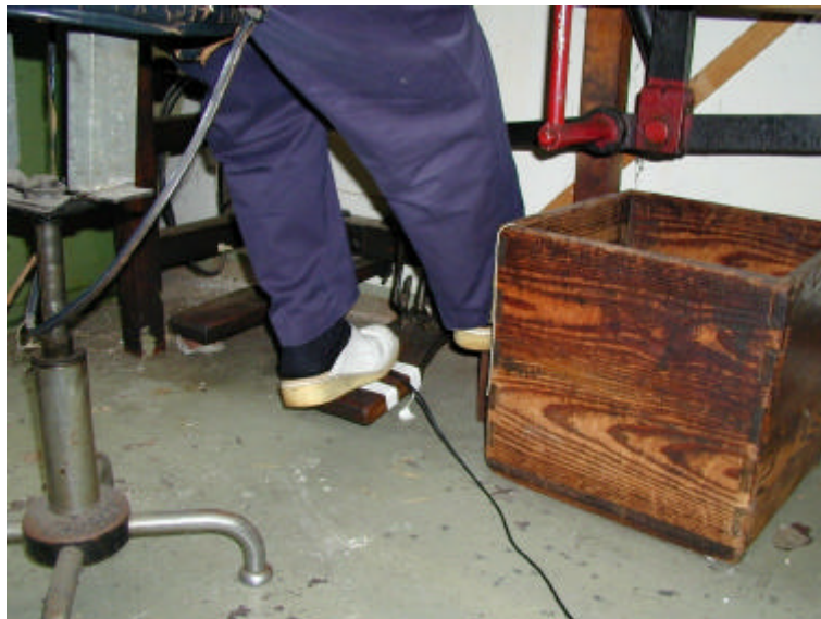
Abbildung 2-24: Pedalkraftmessung an einer Kartenschlägermaschine
