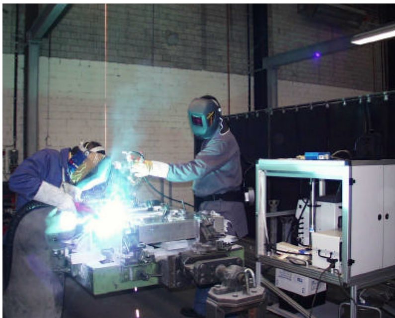
Abbildung 2-14: Messung ultrafeiner Partikel beim Schweißen von Aluminium
