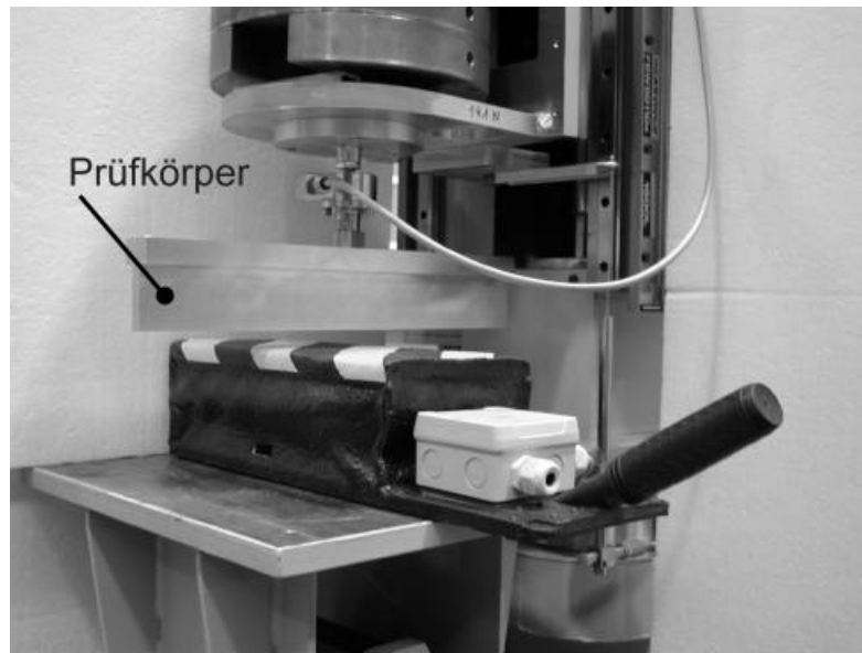
Abbildung 2-30: Schaltkissen auf einer Prüfeinrichtung
