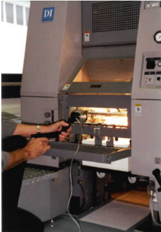
Abbildung 2-21: Messung der IR-Emission einer Druckmaschine
