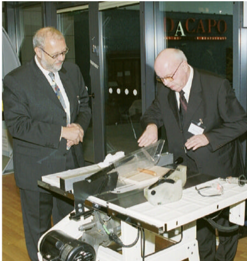
Abbildung 2-33: Neues Handschutzsystem für Kreissägen - Demonstration auf einem Kongress
