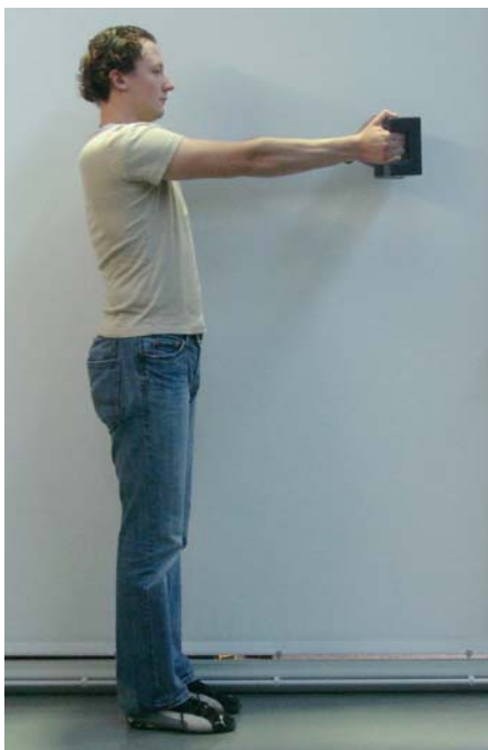
Abbildung 2.12: Körperhaltungen und Lastgewichts- handhabung beim EMG-Kalibrier- vorgang: 100 % RVC
