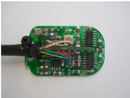
Abbildung 2.6: Aufbau des Surftrak-Sensors (3D-Akzelerometer)
