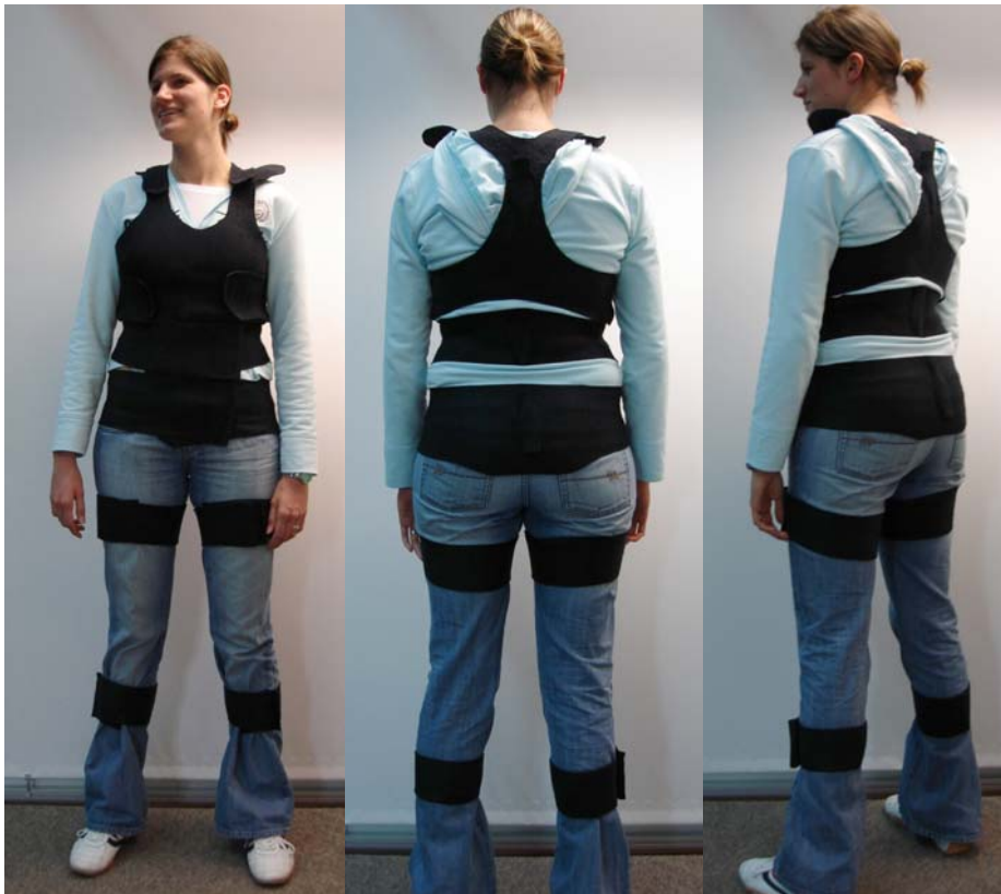
Abbildung 2.19: Anbringung der Surftrak-Sensoren des CUELA-Messsystems mithilfe eines speziell entwickelten Neopren-Gurtsystems
