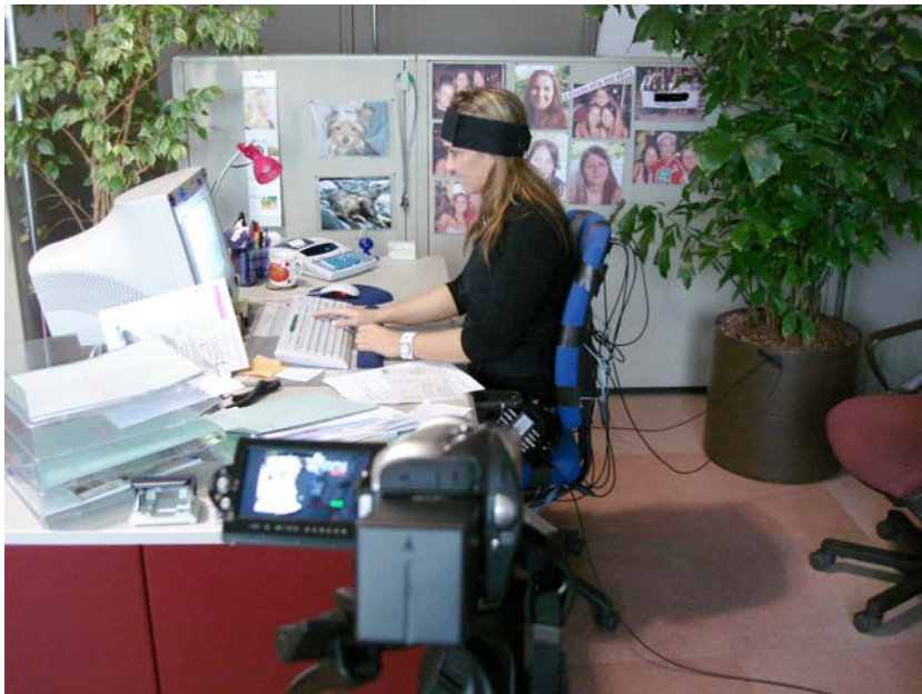
Abbildung 2.18: Probandin mit CUELA-Messsystem auf einem besonderen Büroarbeitsstuhl mit integrierter Messtechnik am Arbeitsplatz während der Feldmessungen
